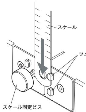
ツメとスケール固定ビスとの間にスケールを差し込み、スケール固定ビスを締める事で、任意の位置にスケールを固定する事が出来ます。
