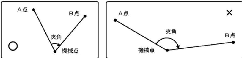
やむを得ず、広い夾角で計算を行う場合は、他の既知点を利用して再度 後方交会を行い、算出値を比較するか他の既知点までの実測距離と計算距離を比較するなどして、計算精度をご確認いただきますようお願いいたします。
