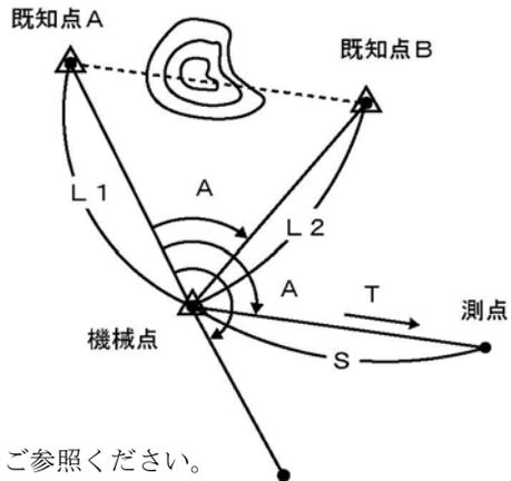
⑩測点までの方向角 **T**、夾角 **A**、距離 **S** を出力。
